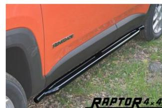
Sottoporta tubolari ancorati in 2 punti al telaio, utilizzano fori già esistenti sul mezzo, bulloneria inclusa nel kit. Non necessitano di ulteriori modifiche per il montaggio.
