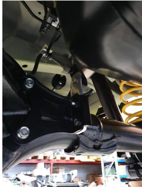
Kit modifica staffa anteriore telaio Suzuki Jimny Sierra dal 2018, permette di montare rialzi maggiorati su qualsiasi modello di Jimny anche estremi, evitando che l'albero di trasmissione tocchi sul telaio.
